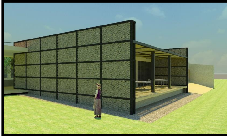
Perspectiva de muro gavión. Área de trabajo abierta.
