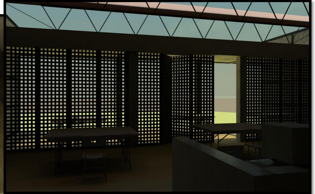
Puertas de celosía en madera corredizas. Área de trabajo cerrada. Unidad de Investigación
