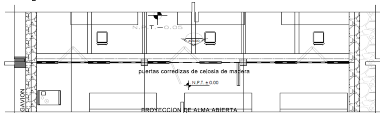
DT-01 PLANTA DE CELOSIA (AREA DE TRABAJO)
