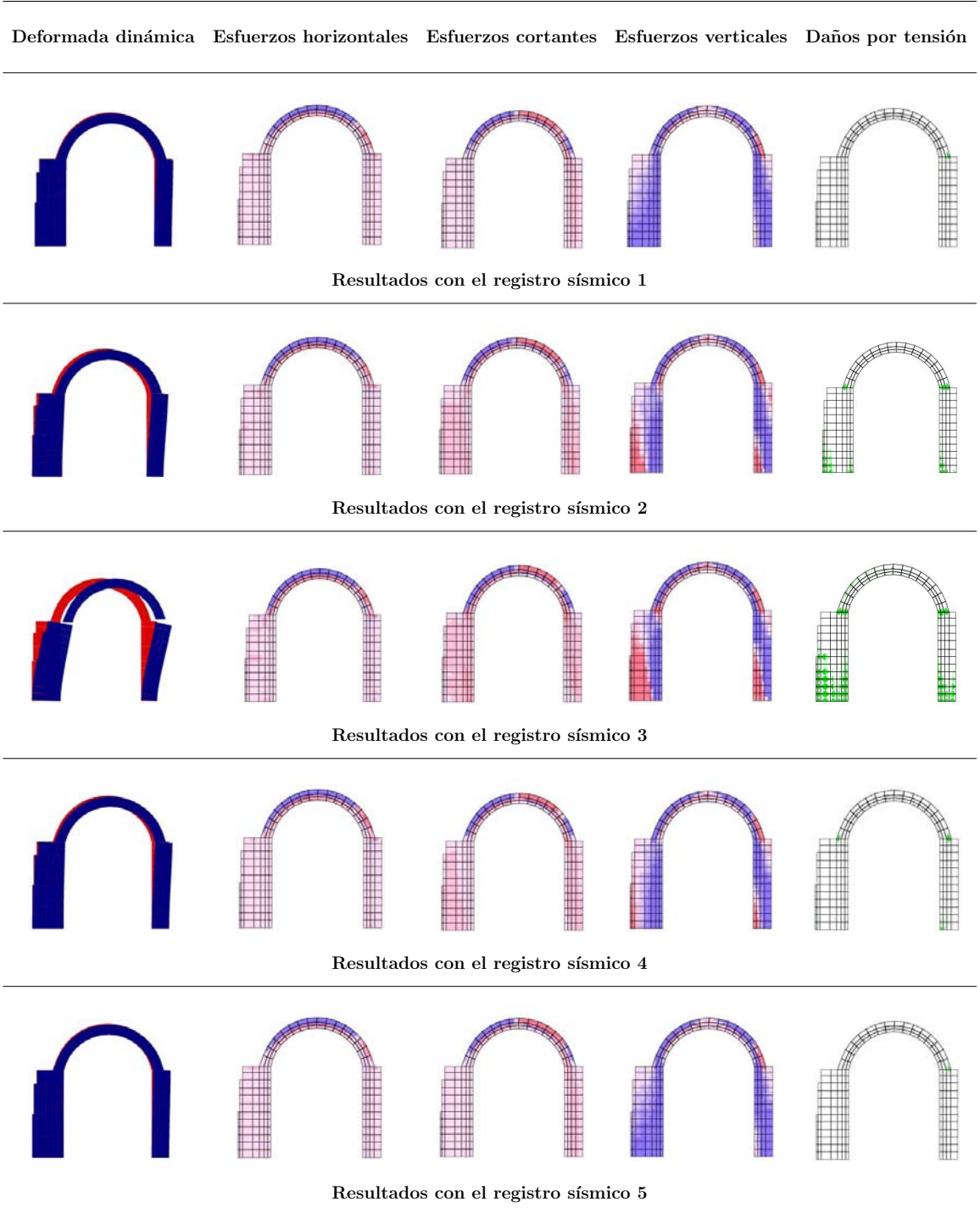
Figura 39: Instantes más críticos durante los análisis con San Bartolomé y mapa de daños por tensión
