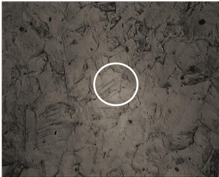
Figura 5.1.7. Microestructura de la pieza con tratamiento térmico 450°C - 1 hora. Microscopio óptico. Agua Regia.
