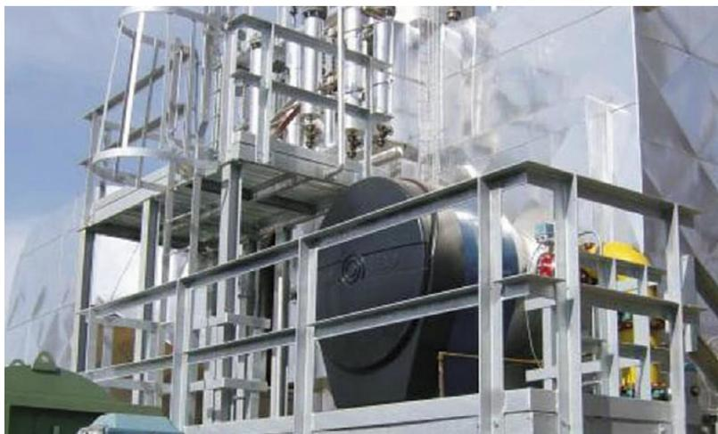
Figura 61: Quemadores tipo JBM-HP (Fuente: <http://emcombustion.es/contacto/>)
