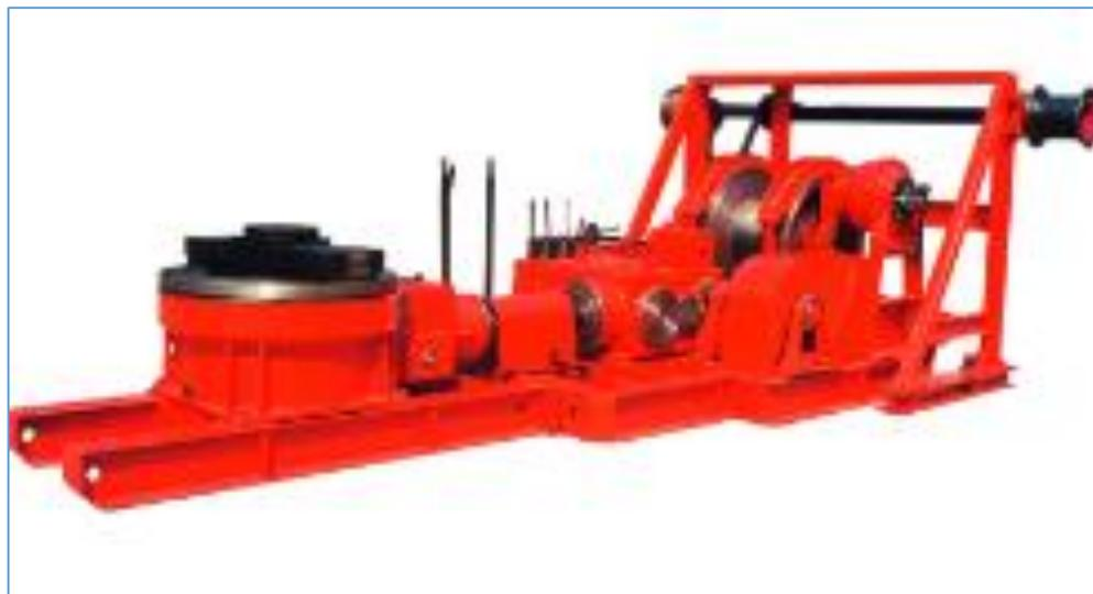
**Figura 123:** Equipo Perforación De Pozos SPS2000. (Fuente: <http://www.drilling-rig.es/cmb-drill-rig.html>)
