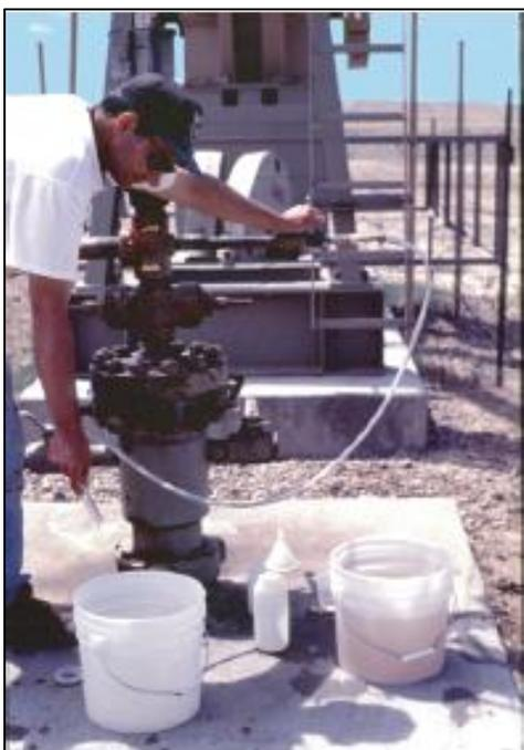
**Figura 44:** Toma de muestra de agua a boca de pozo de GAMC. Muchos parámetros, tales como el PH, la alcalinidad y contenido de metales, cambian rápidamente una vez que se elimina el agua del pozo (Foto).
