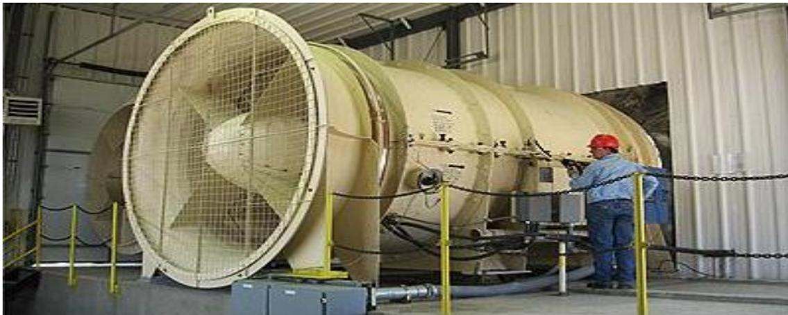
**Figura 25.** Ventilador de una mina de carbón (Foto)
