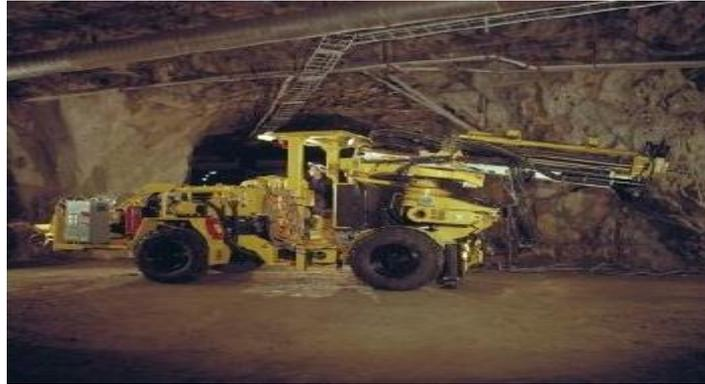
**Figura 66:** Perforadora Simba 1354 (Foto de Atlas Copco Mexicana SA de CV)
