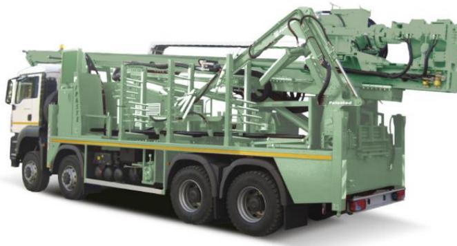
**Figura 77:** Perforadora FS 400 (Fuente: <http://www.fraste.com/es/contactos>)
