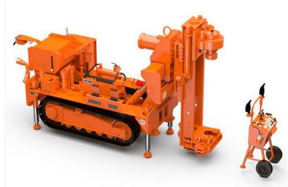
**Figura 70:** Perforadora CMM 2 (Foto: <http://www.joyglobal.com/es/contact-forms/cont%C3%A1ctenos>)
