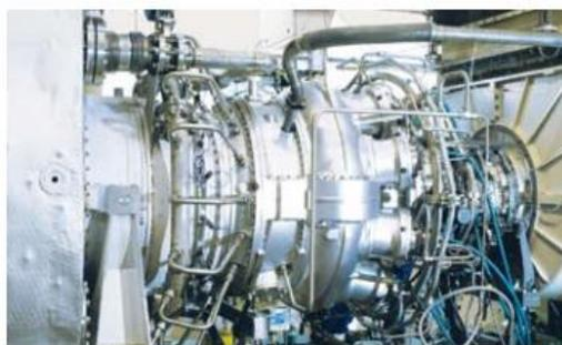
**Figura 88:** Generador SGT-200 (Fuente: <http://www.energy.siemens.com/hq/en/fossil-power-generation/gas-turbines/>)
