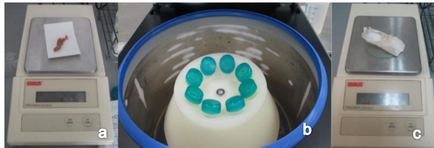
Figura 24. Determinación CRA a) Pesado muestra, b) Centrifugado y c) Pesado de papel filtro
