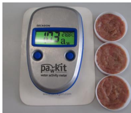
Figura 23. Determinación de actividad de agua
