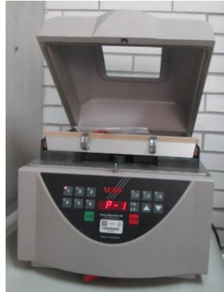
Figura 20. Envasado al vacío de hamburguesas
