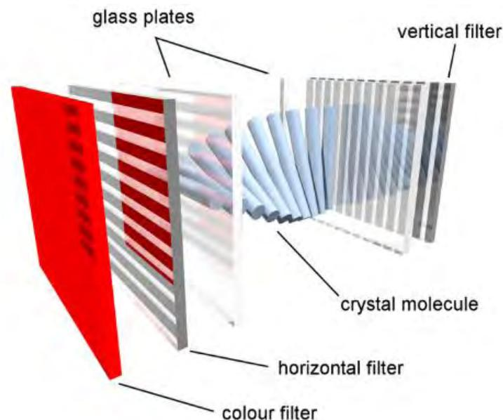
1.3.2 Diagrama de un monitor LCD<sup>5</sup>
