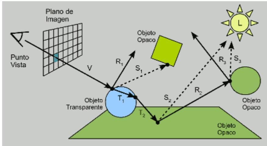
**Figura 2.5.1 Esquema de funcionamiento del Raytracing<sup>23</sup>**
