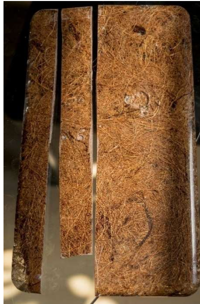
Figura 23. Corte de probetas tipo epo ale del molde principal con la ayuda de una segueta.
