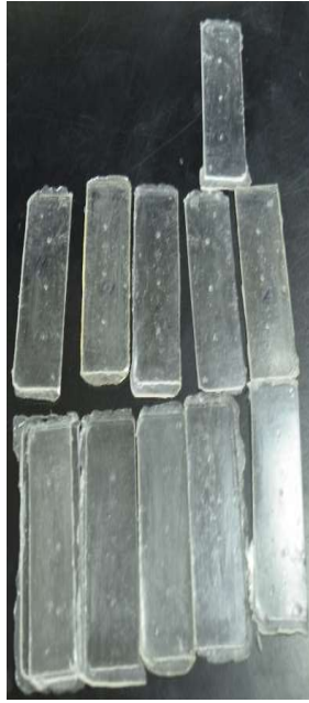
Figura 19. Probetas tipo epo con las medidas de las normas ASTM.
