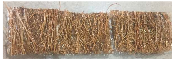
Figura 29. Probeta tipo epo trans fracturada
