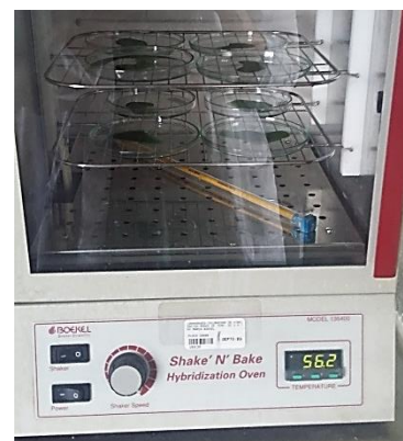
Fig. S.7. Deshidratación de las células en horno para medir peso seco.
