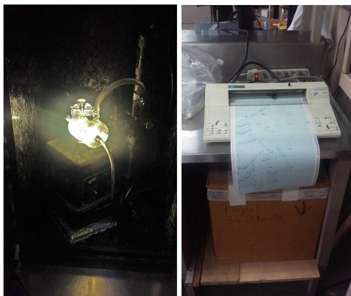
Fig. S.5. Caja negra con cámara de vidrio y electrodo de oxígeno durante fase de iluminación artificial (izq.). Registrador de trazos de consumo oxígeno y fotosíntesis (der.).
