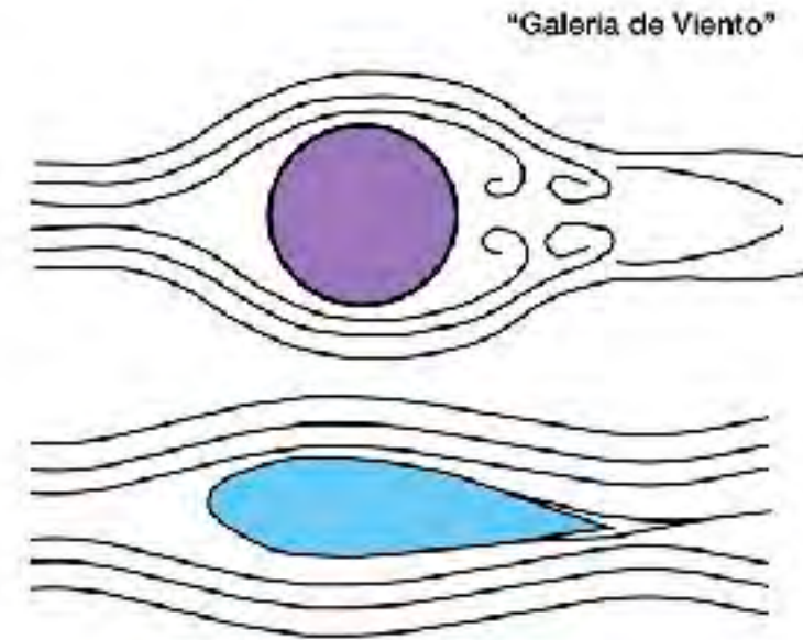
Croquis 12: Esquema de funcionamiento de la galería de viento. Elaboró Diana Carolina Nava Ramírez (2017).
