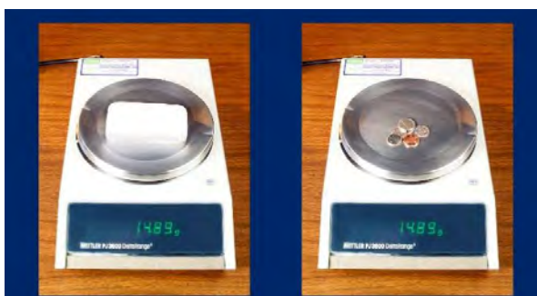
Figura 7. Los aerogeles son extraordinariamente ligeros. 22 Aerogel (izquierda) es tan liviano como 4 pequeñas monedas.
