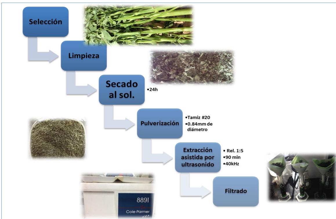
Figura 10. Diagrama de proceso para la extracción asistida por ultrasonido.
