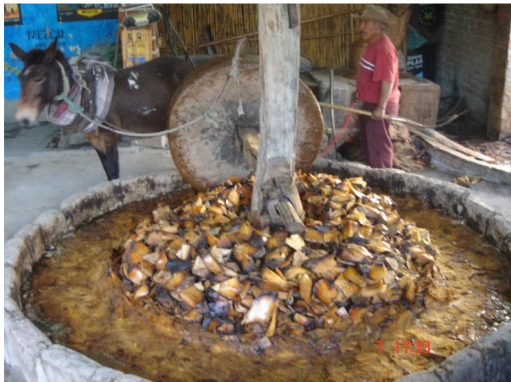
Figura 4. Molienda de las piñas cocidas en una tahona tradicional de madera.
