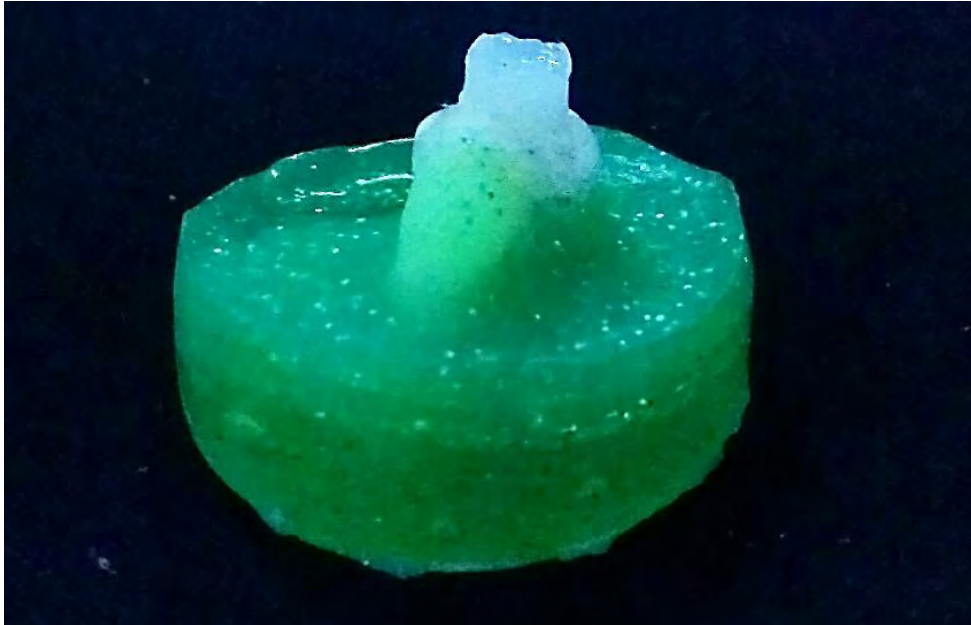
Ilustración 13 .Botón del cemento para brackets, el cual será sometido a cizallamiento
