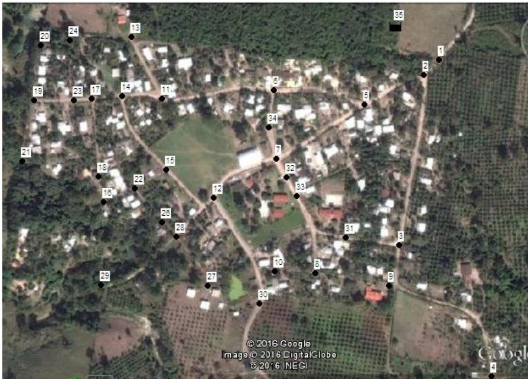
Fig. V. 10 Ubicación y numeración de nodos y tanque de regulación. Fuente: EPANET
