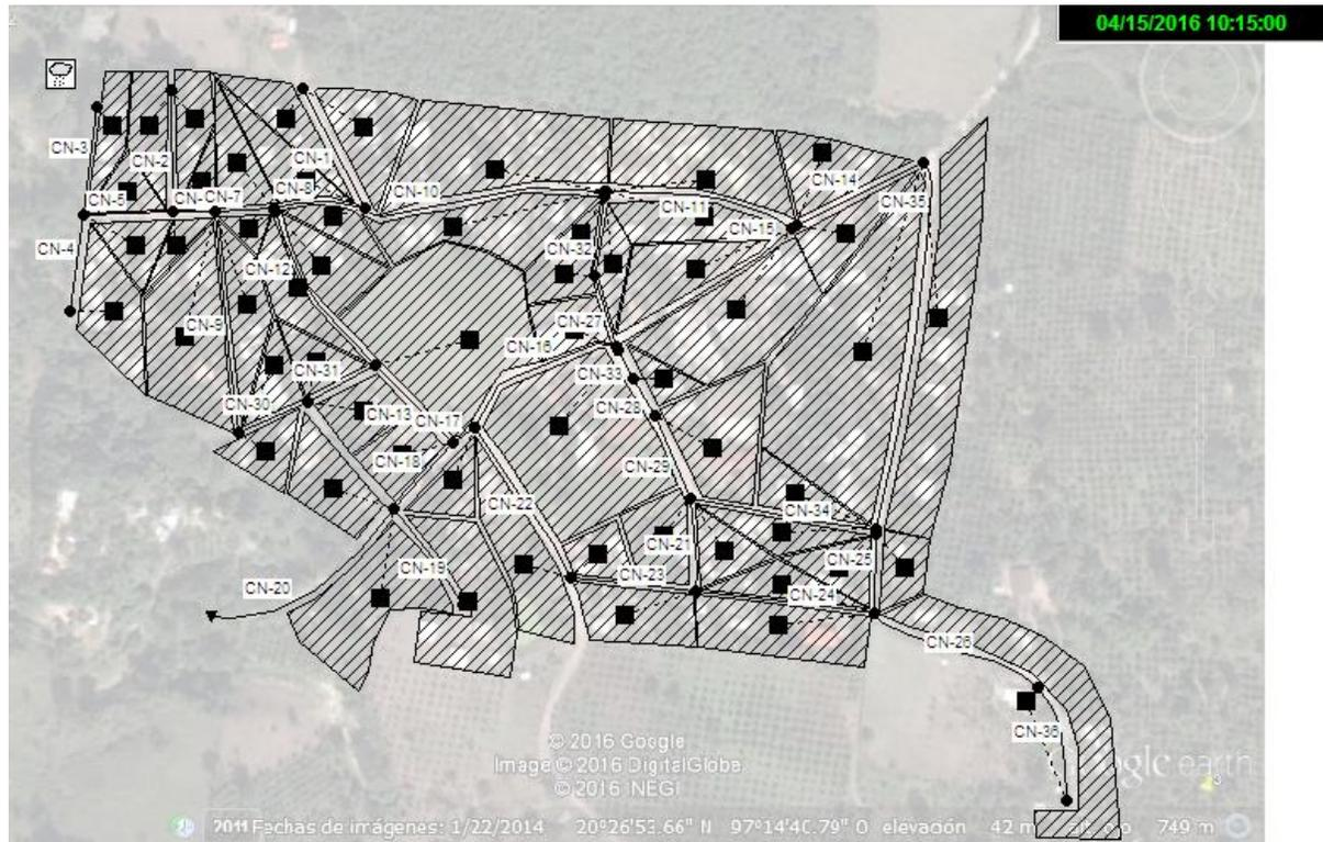
Fig. C- 5 Ubicación y numeración de las tuberías del sistema de alcantarillado
