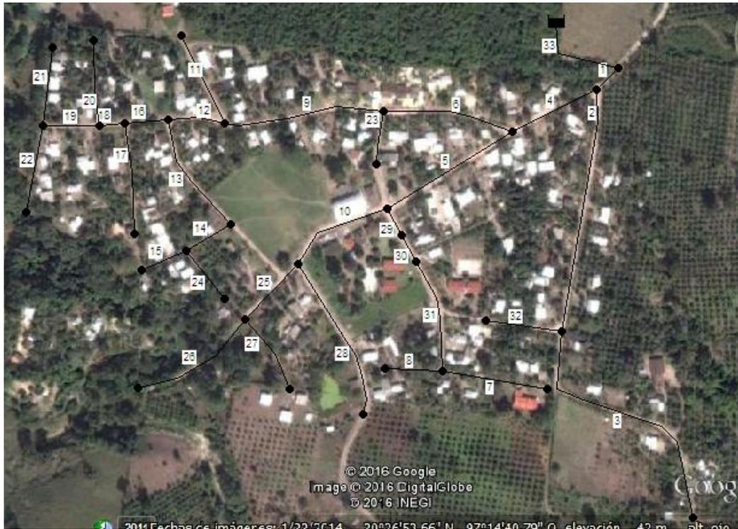
Fig. V. 11 Ubicación y numeración de las conexiones o tuberías. Fuente: EPANET
