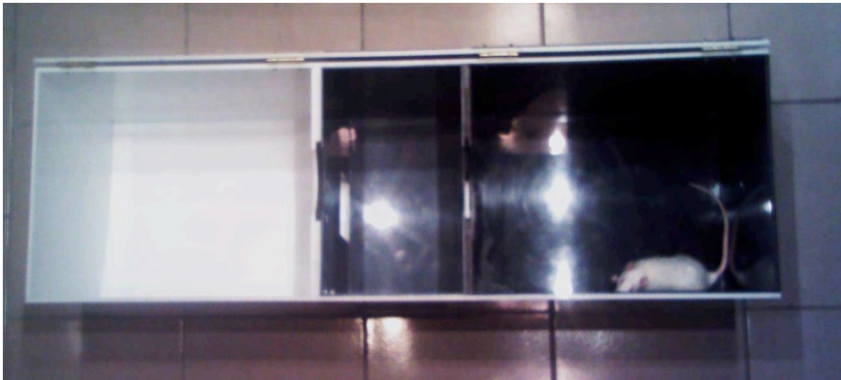
Figura 8. Caja de condicionamiento de preferencia de lugar (CPL). El compartimiento de la izquierda es blanco con una textura rugosa en el piso, mientras que el de la derecha es negro y tiene impregnadas las paredes con ácido acético (olor a vinagre). Al centro se encuentra el compartimiento de transición en donde es colocado el animal al inicio de la prueba.
