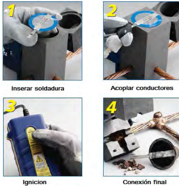
Ilustración 12 Instructivo de soldadura exotérmica marca CadWeld
