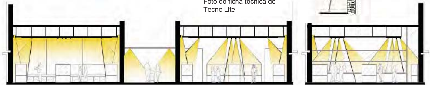
Ejemplo del efecto de la iluminación artificial propuesta, vista en corte
