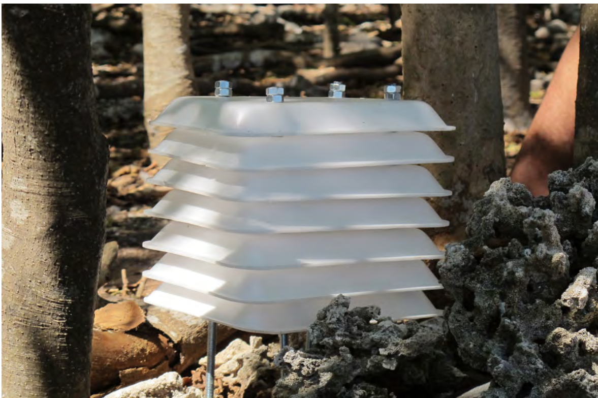
Figura 4. Escudo de radiación utilizado para medir la temperatura del aire. Fotografía por Oscar Sánchez-Macouzet.
