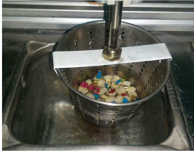
Imagen 6 Foto de las muestras iniciando los 500 ciclos en el termociclado.
