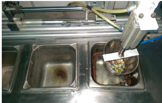
Imagen 5: Máquina Termocicladora desde una vista frontal y una vista superior antes de comenzar a termociclar las muestras.
