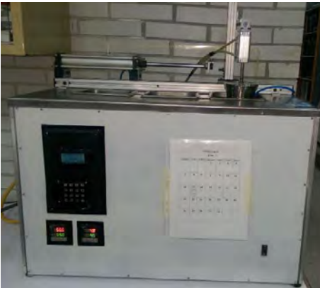
Imagen 5: Máquina Termocicladora desde una vista frontal y una vista superior antes de comenzar a termociclar las muestras.
