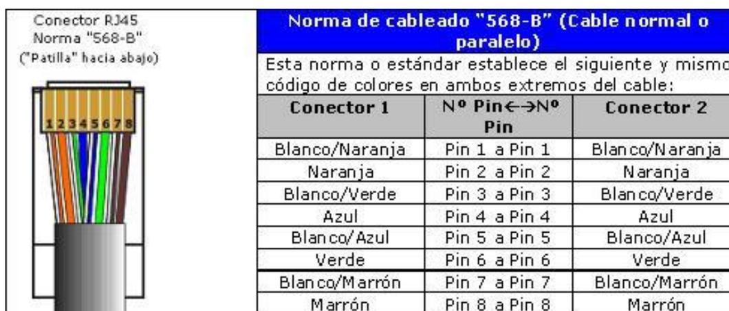
Fig. 1.4.2 Ordenamiento de cables RJ-45.<sup>4</sup>
