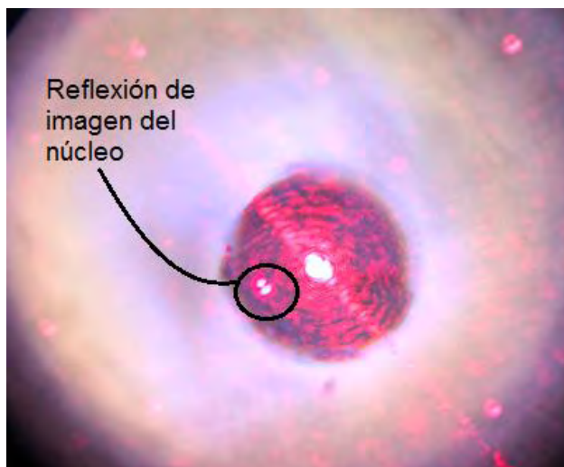
Figura 4.25 Radiación de un láser de HeNe en una fibra tipo PANDA.
