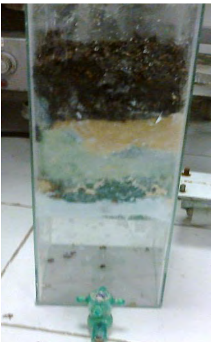
Imagen 6. Biofiltro presentado por el grupo Ri. como propuesta de tratamiento del agua residual de la UTTEC.
