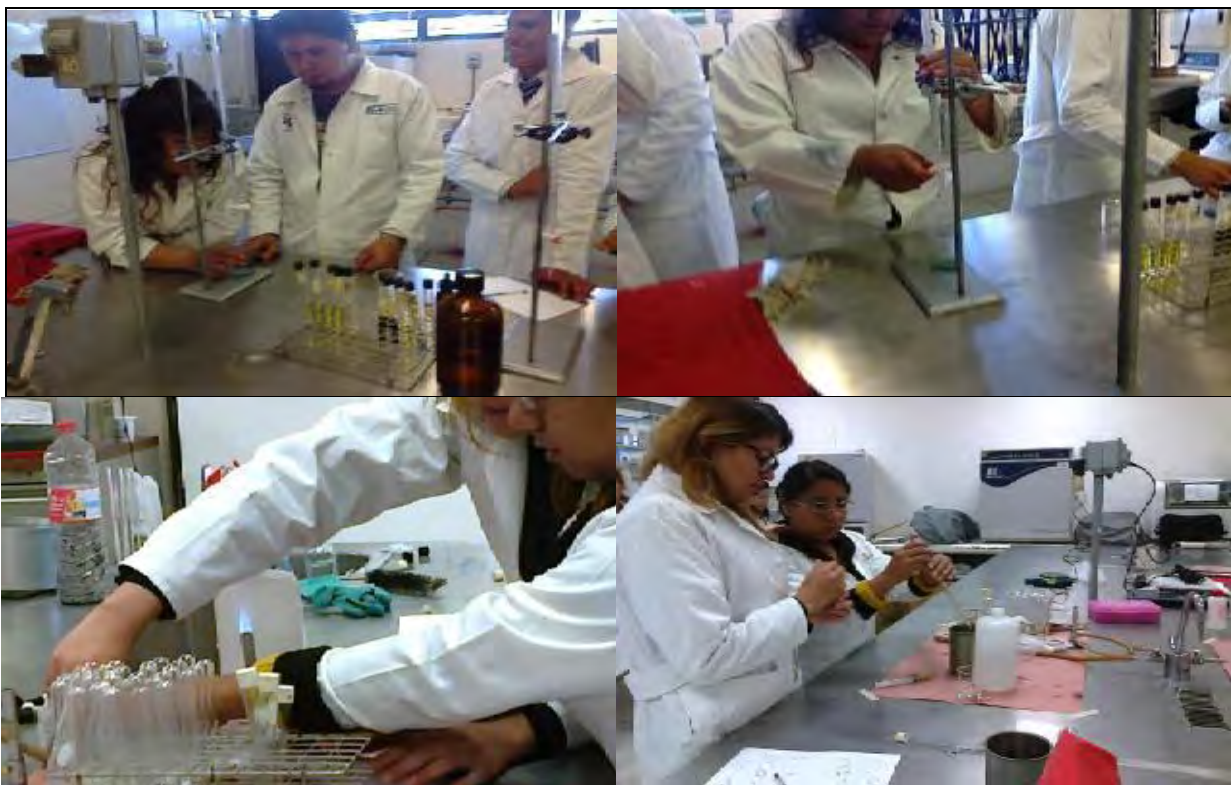
Fotografías de determinación de DQO en una muestra de agua residual, preparación de reactivos, vaciado de los tubos, titulación de la muestra. (Grupo Testigo)
