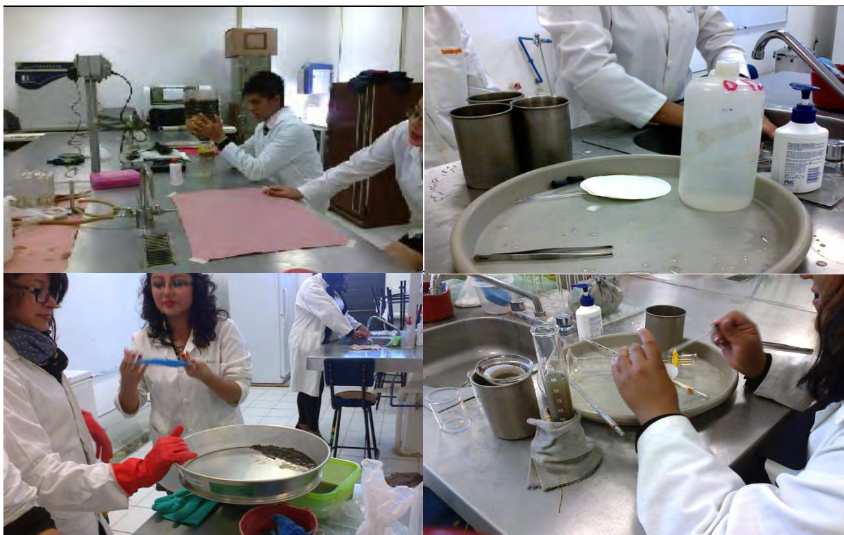
Fotografías sobre la determinación de SST, lavado de material, filtrado del agua residual, preparación de la muestra.
