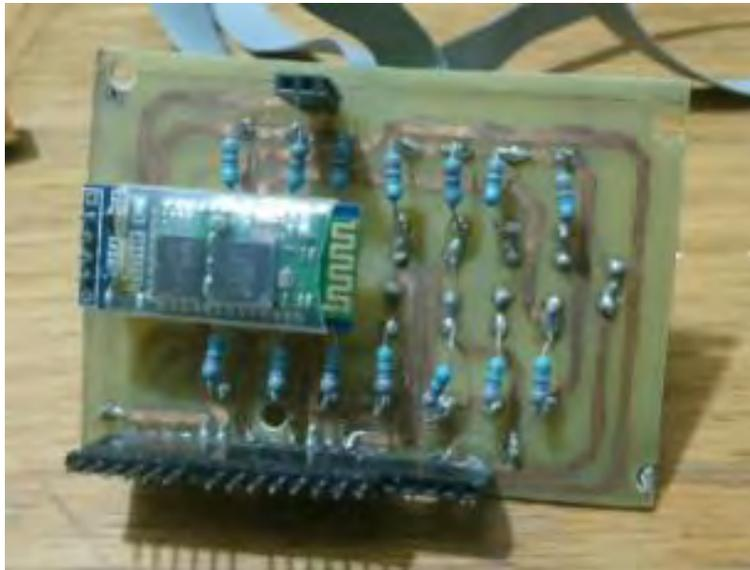
Figura 64. Circuito ensamblado para montaje en la placa arduino. (Elaboración propia)
