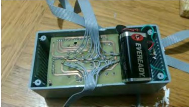
Figura 68. Circuito montado sobre la placa Arduino y conectado a alimentación de 9V. (Elaboración propia)
