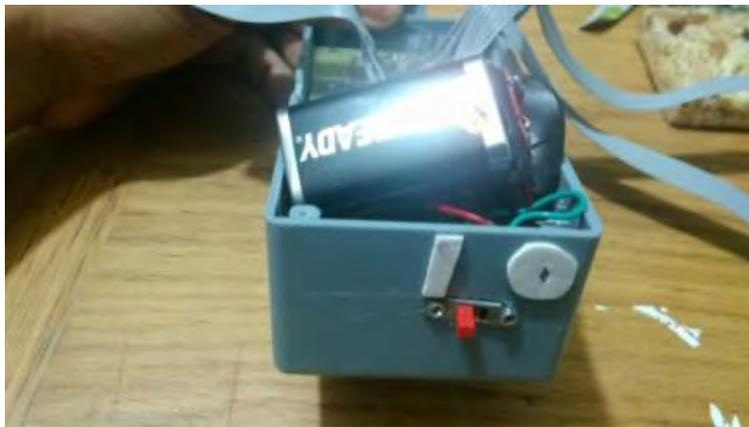
Figura 69. Switch de encendido del circuito montado sobre la carcasa. (Elaboración propia)
