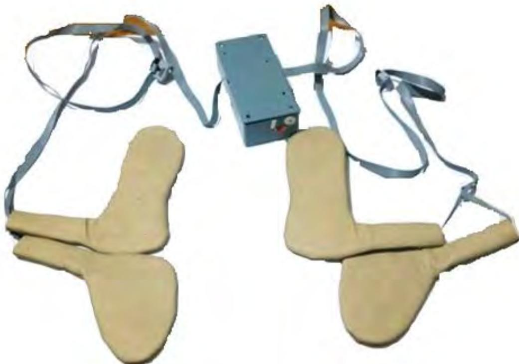
Figura 71. Plantillas instrumentadas con circuito montado en su carcasa. (Elaboración propia)
