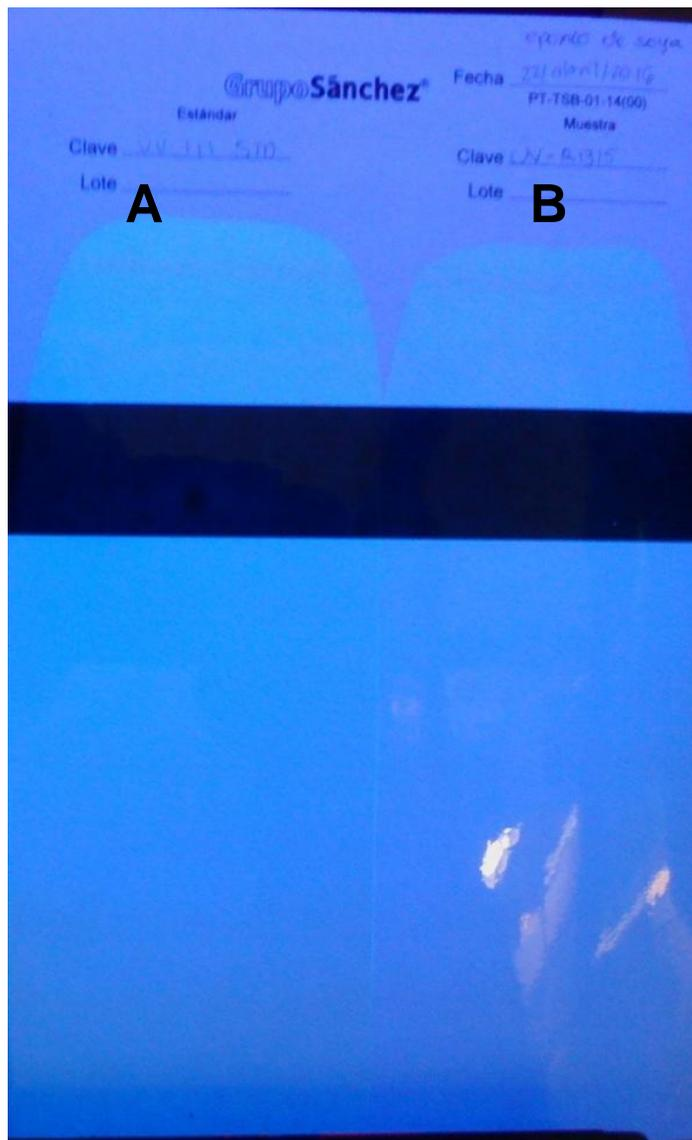
**Figura 20.** En el lado A se presenta la prueba de la muestra estándar y del lado marcado con la letra B se muestra la prueba del barniz preparado con la muestra de AESO experimental preparado con Amberlyst-15.
