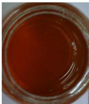
**Figura 11.** Resina acrilada usando Trietilamina como catalizador.
