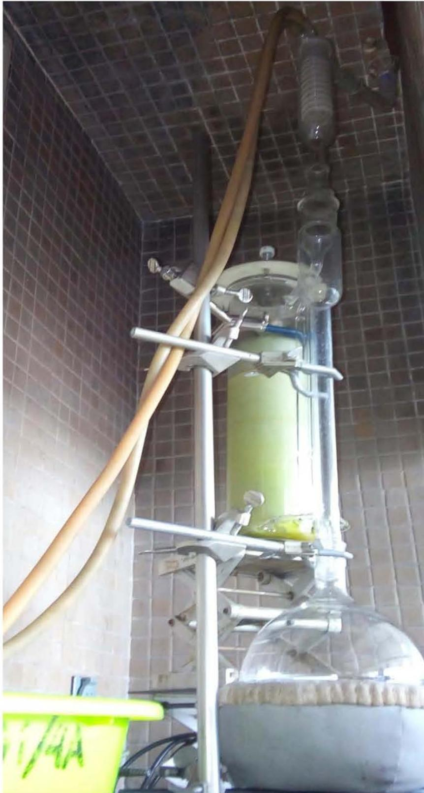
**Figura 6. Equipo utilizado para la extracción de grasa**
