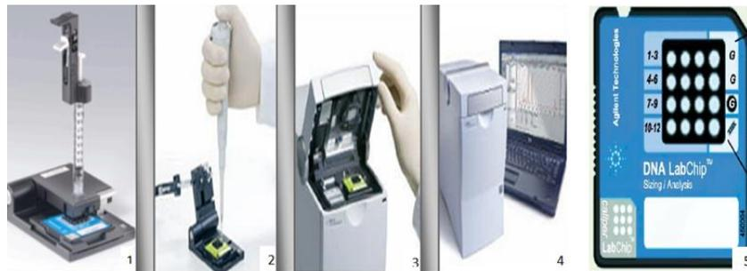
**Fig. 7: 1.-Estación donde se carga el “chip” con el “gel-dye mix”. 2.- Colocación de las muestras. 3.- Colocación del chip en el Bioanalizador 2010. 4.- Bioanalizador 2010 y un equipo de cómputo en el cual se lleva a cabo la cuantificación. 5.-“Chip”**
