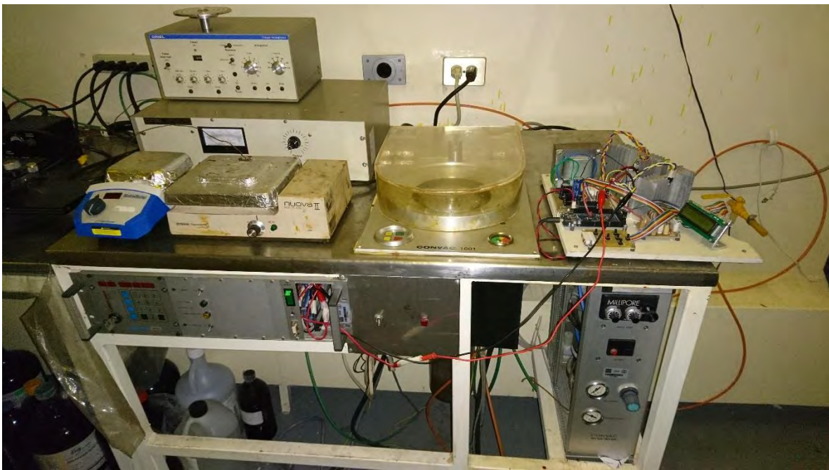
Figura 38. Sistema de deposición desarrollado
