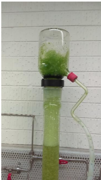
Ilustración 4. Ozoflotación de microalgas
