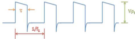
Figura 49 Diagrama de pulsos: onda continua
