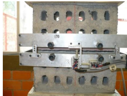
b) Falla en la junta vertical
