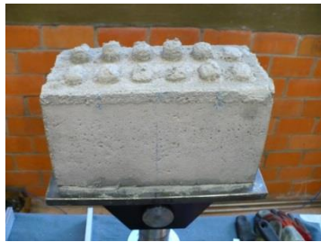
a) Falla en la junta horizontal
