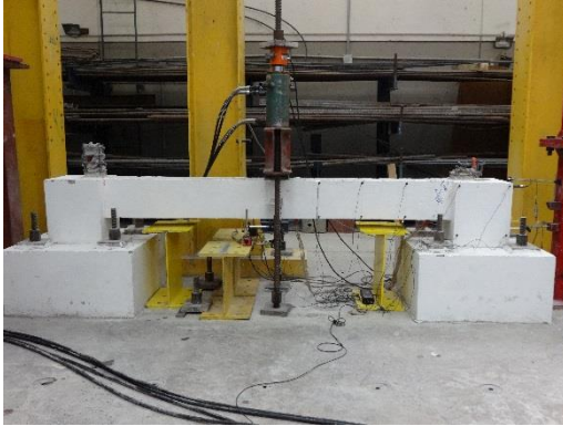
a) Ensayo de viga a carga puntual
