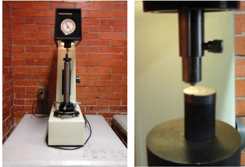
Figura 5.6 Preparación de la muestra grado NACHI FAX55 para pruebas de dureza.
