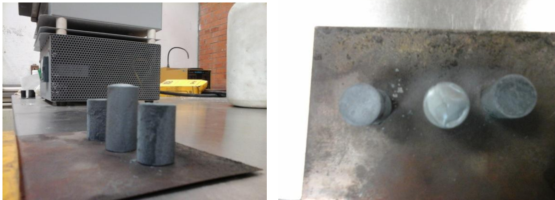
Figura 5.11 Probetas de acero grado NACHI FAX55 templadas al aire.
