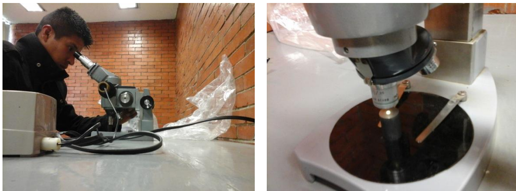
Figura 5.4 Enfoque de la lente del microscopio en la superficie de una probeta de acero grado NACHI FAX55.
