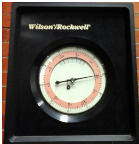
Figura 5.8 Carga de 10 kg del durómetro Wilson/Rockwell en escala HRC.
