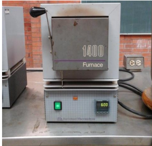
Figura 5.12 Revenido de las probetas grado NACHI FAX55 en el horno eléctrico a 600°C.
