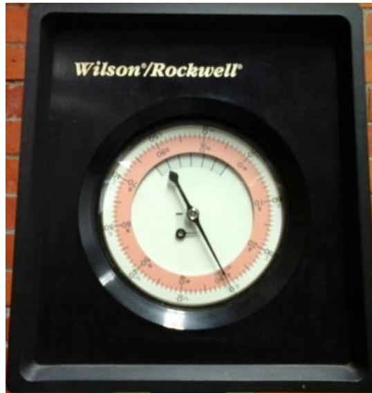
Figura 5.7 Calibrado a cero el durómetro Wilson/Rockwell.
