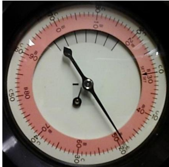
Figura 5.10 Lectura en la caratula del durómetro después de aplicar la carga de 150 kg.
