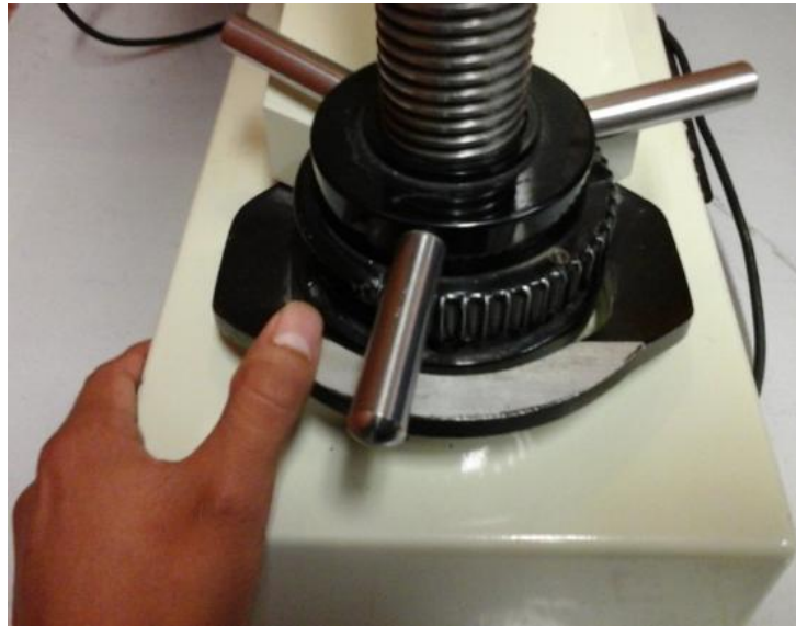
Figura 5.9 Aplicación de la carga máxima de 150 kg para obtener la dureza de la probeta de acero grado NACHI FAX55 en una escala HRC.
