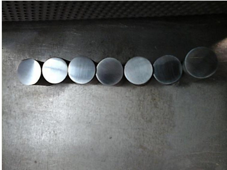
Figura 5.2 Probetas grado NACHI FAX55 desbastadas hasta la lija número 1000.
