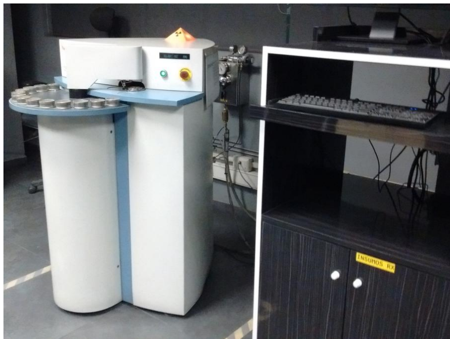
Figura 6.8 Espectrómetro de la marca Spectro perteneciente a la empresa Gerdau utilizado para obtener la composición química del acero.
