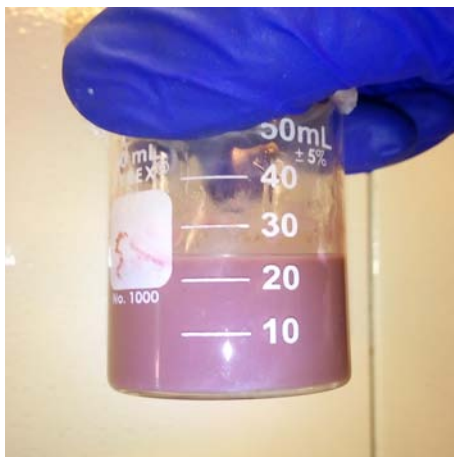
Figura 6.7: Mezcla de nanotubos de carbono multipared, ácido fosfórico, ácido sulfúrico y permanganato de potasio después de una hora en agitación a 80 °C.
