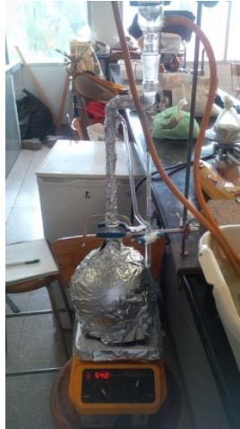
Figura 21. Extracción del aceite esencial de orégano mediante hidrodestilación.
