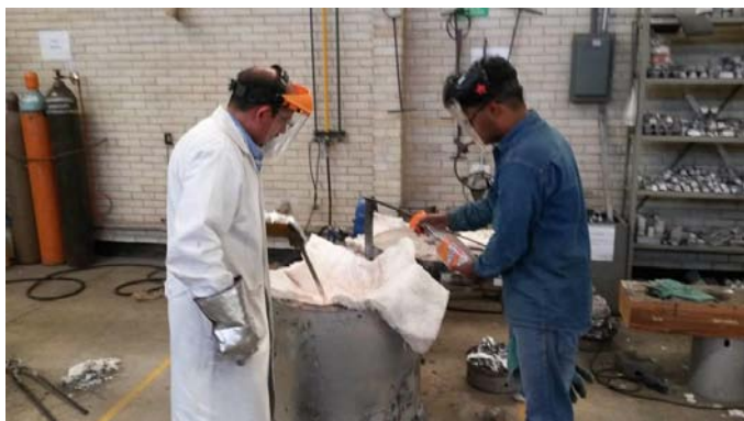
Fig. 10. Gasificación de aluminio con atomizador de agua.
