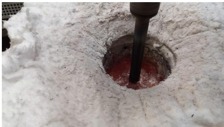
Fig. 14. Desgasificación con rotor inyector de grafito, usando Ar.
