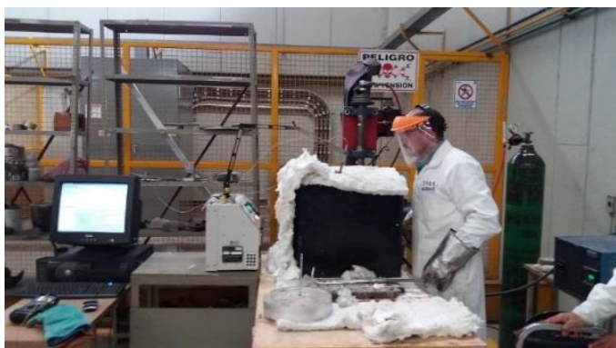
Fig. 11. Determinación de la concentración inicial de hidrógeno.
