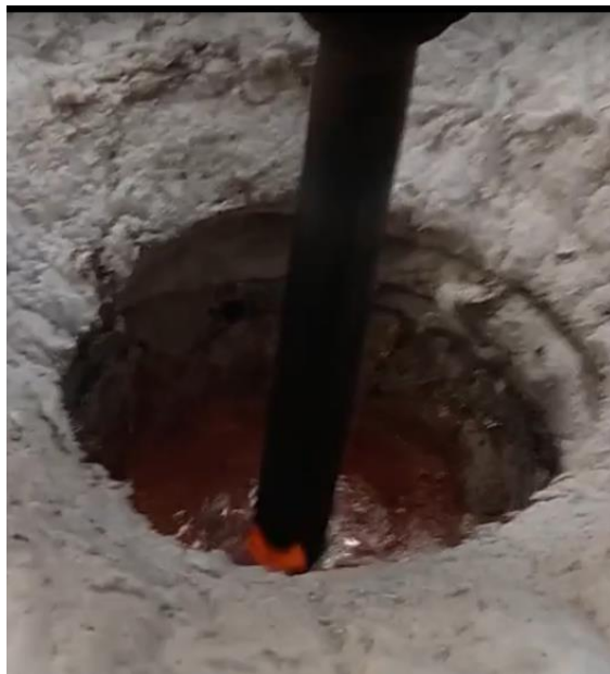
Fig. 26. Explosión emergente del aluminio causada por la combustión de H_2 .
