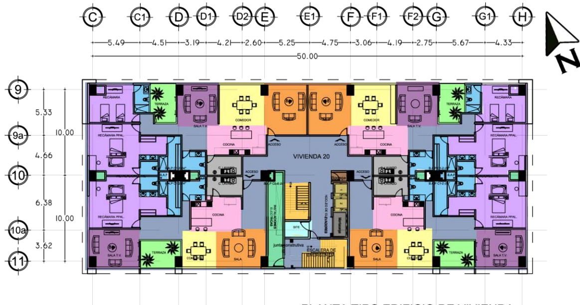
PLANTA TIPO EDIFICIO DE VIVIENDA
