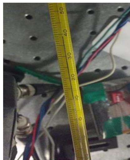
*Figura 7.2.8 Temperatura de horno 40°C y temperatura termómetro 39°C*
