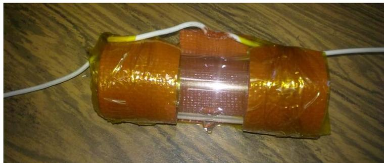
**Figura 4.2.3 Celda de vidrio, cinta kapton y resistencias**
