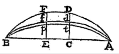
Figura 2.13: Esquema de Taylor para determinar el movimiento de una cuerda vibrante. La figura inicial que él asume es una curva sinusoidal, la cual se conserva en todo momento de la vibración.
