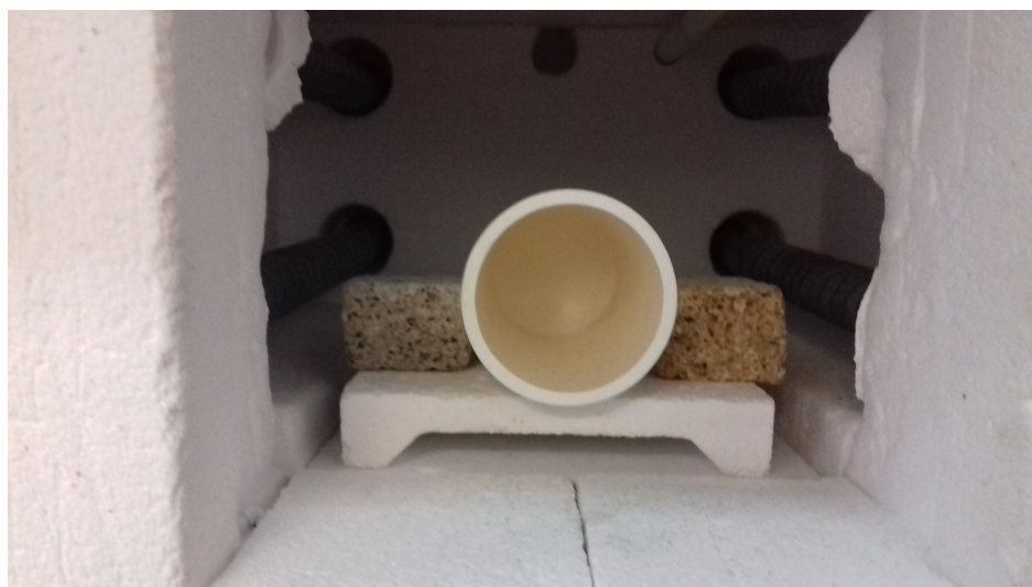
Figura 4.6. Tratamiento térmico de las muestras a 550°C por 8 h.
