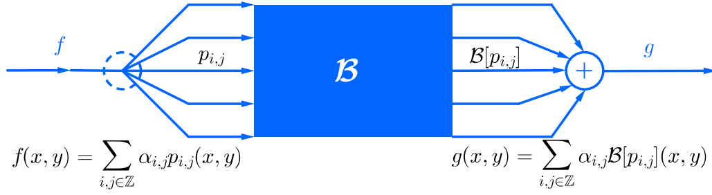
Figura 4.8: Descomposición de f en funciones elementales p_{i,j} que se transforman bajo el operador \mathcal{B} y se reintegran por linealidad en g = \mathcal{B}[f] .
