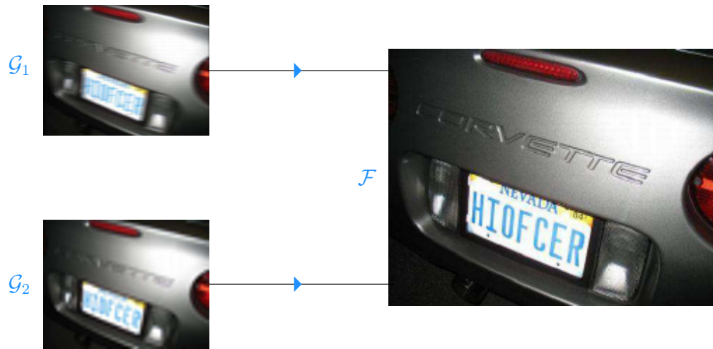
Figura 4.5: Super-resolución. A partir de dos imágenes desenfocadas \mathcal{G}_1 y \mathcal{G}_2 de una placa de automóvil de 118 \times 90 píxeles, obtener una imagen \mathcal{F} con menos degradaciones de 236 \times 180 píxeles
