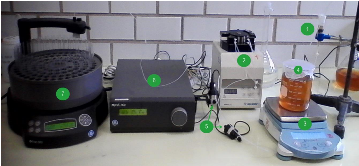
Figura 13. Dispositivo experimental: 1) Columna de suelo empacada en una punta de pipeta, 2) Bomba peristáltica para mantener un flujo constante a través de la columna, 3) Balanza para verificar el flujo aplicado, 4) Solución de riego (Vinaza diluida 50 veces con \text{CaCl}_2 0.01 M), 5) Electrodo de pH y conductividad eléctrica, 6) Monitor de pH, CE y temperatura, 7) Colector de fracciones para discretizar el flujo de lixiviado.
