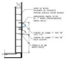
FIJACION EN PARED DE TUBERIAS HIDRAULICAS B/E
