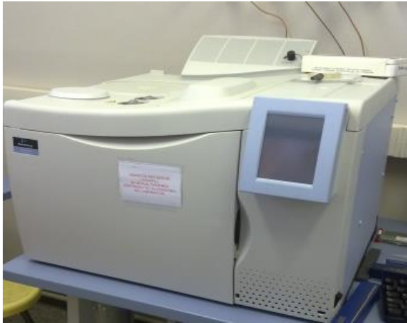
Figura 3. Cromatógrafo de gases Perkin Elmer Clarus 500 computarizado, utilizado para el análisis de lípidos de raíz en Arabidopsis thaliana en AGO5+P, AGO5-P, ago5+P, ago5-P, Col0 +P y Col0 -P.
