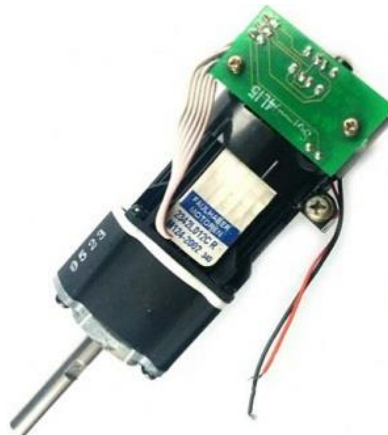
Figura 3.5. 6: Motor Faulhaber 23421012cr. [26].
