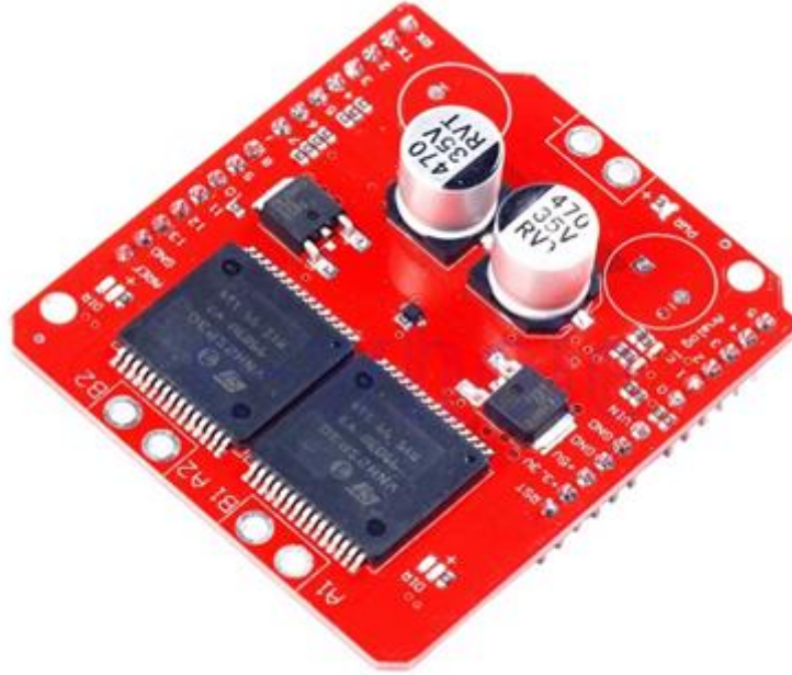
Figura 3.6. 2: Puente H vnh2sp30-monster moto shield.
