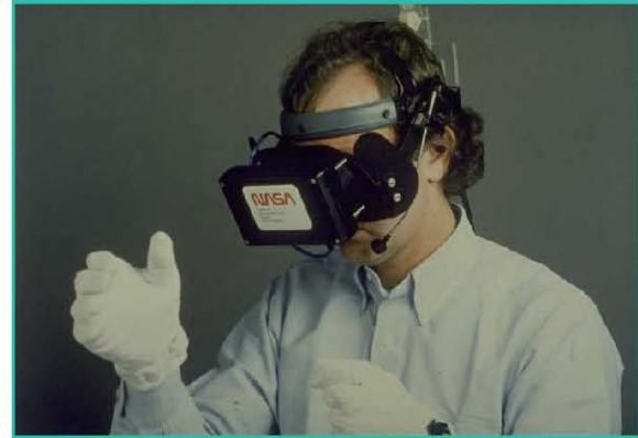
Imagen 7. Lentes con imagen estereoscópica para la NASA. Recuperada de: http://warrenrobinett.com/
