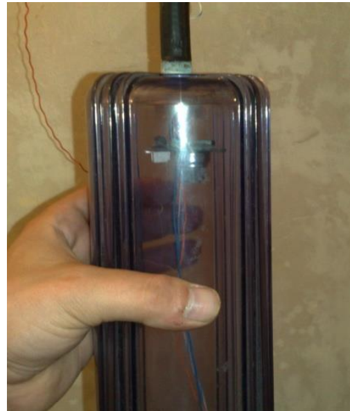
Figuras 16 y 17. Sistema de registro del metano (MQ-2)
