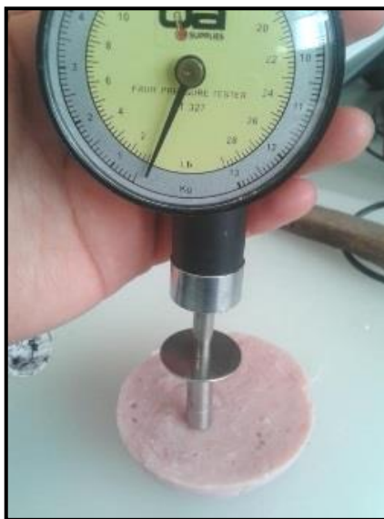
Figura 24. Determinación de la resistencia a la deformación
