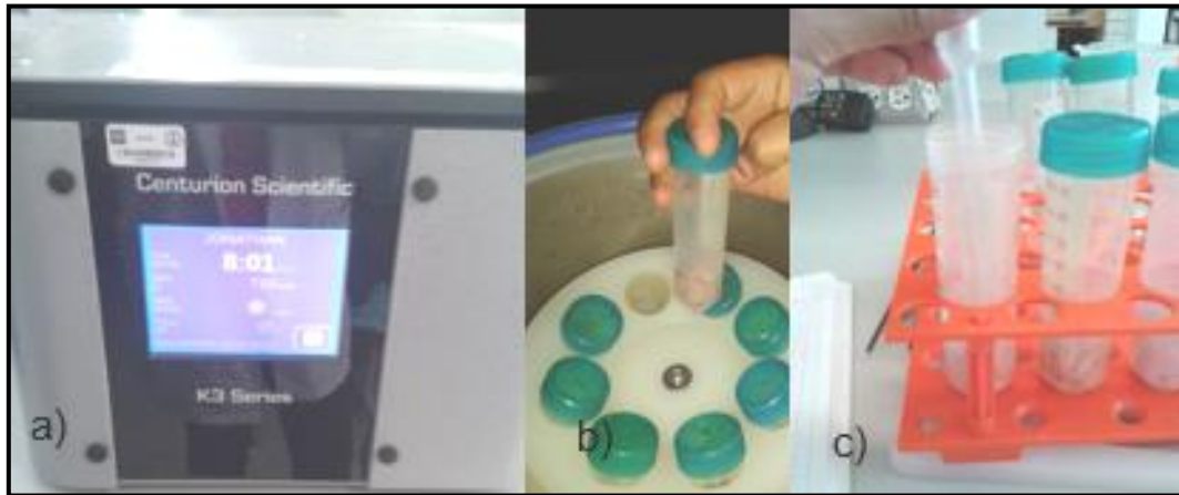
Figura 25. a) Centrifuga CENTURION SCIENTIFIC LTD, modelo K20103R, b) colocación de los tubos en la centrifuga y c) medición del volumen del sobrenadante
