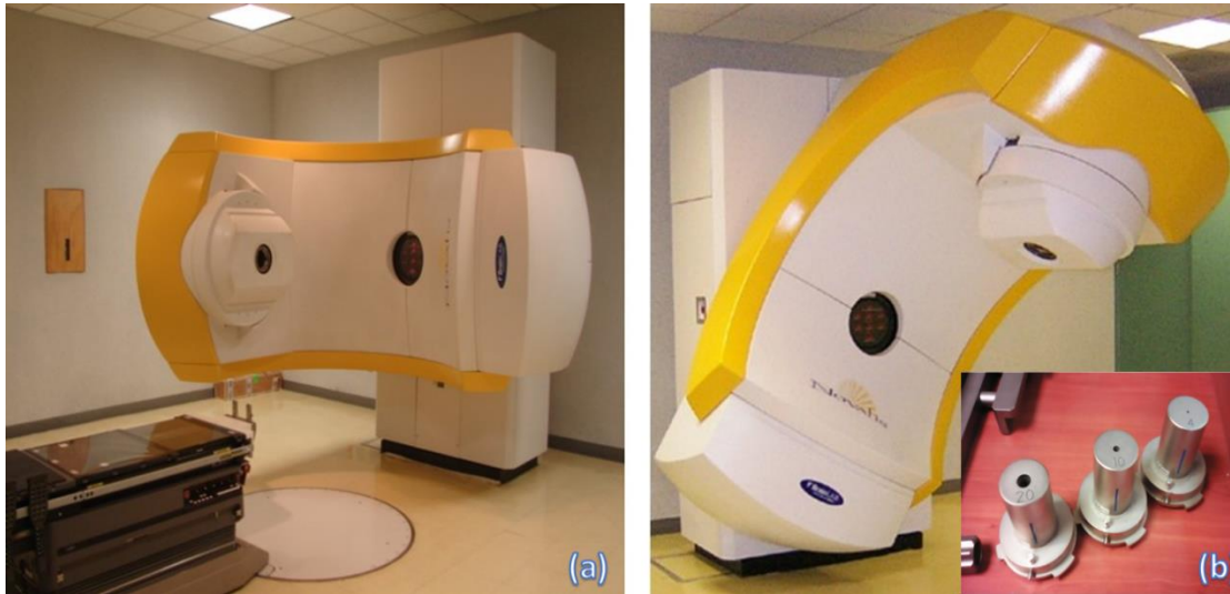
Figura 3.1 (a)Acelerador lineal dedicado Novalis perteneciente al Instituto Nacional de Neurología y Neurocirugía (b) Sistema de colimadores circulares (conos de 4, 10 y 20 mm a isocentro).
