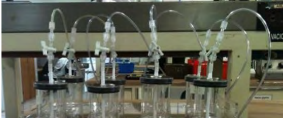
Figura 21. Control de la presión en cada reactor
