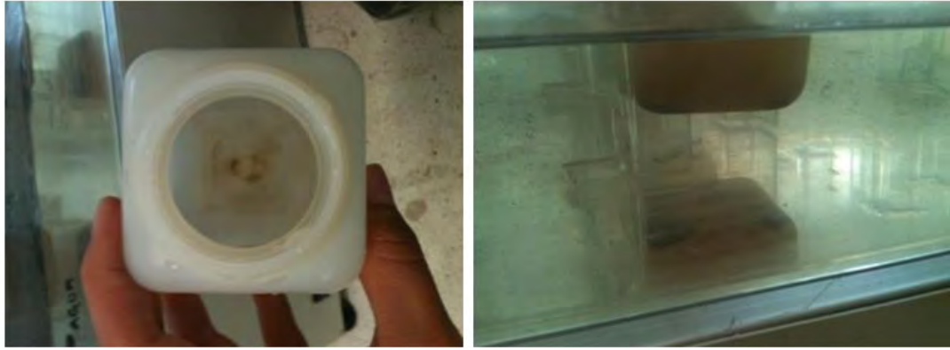
Figura 14. Acumulación de sedimento en los reactores del equipo LABQA-2011
