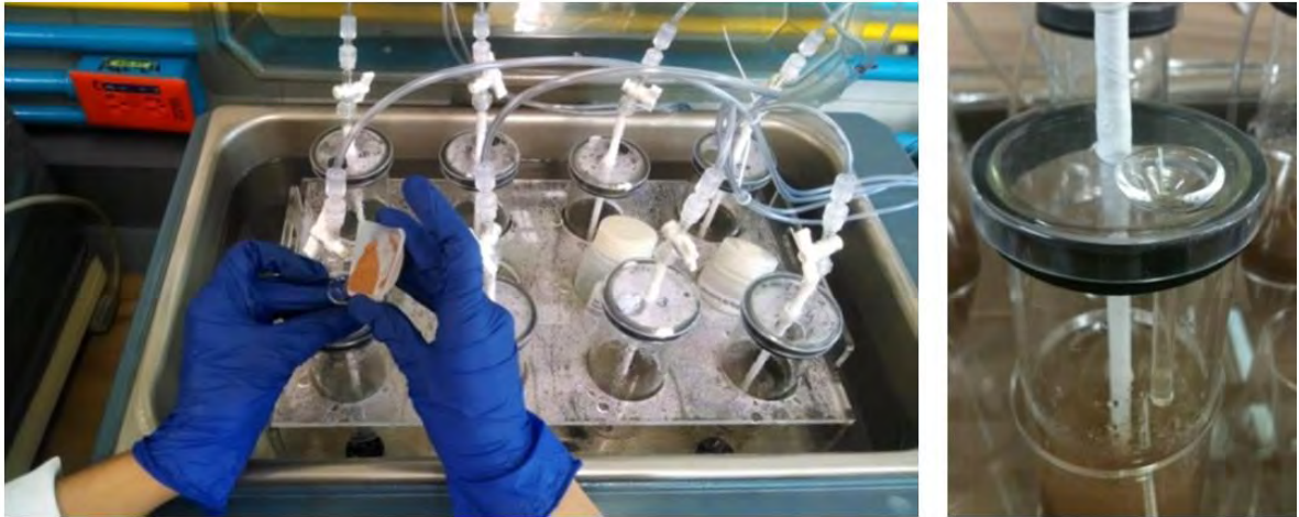
Figura 19. Introducción de reactivos y muestras a través de embudos en el equipo LABQA-2014
