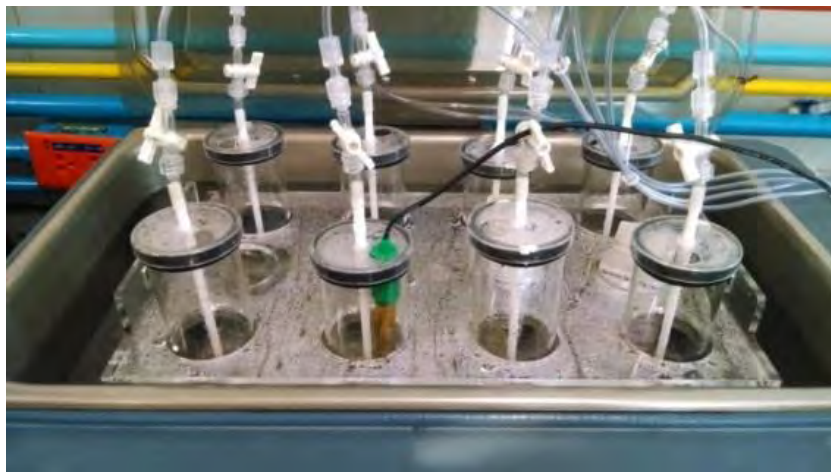
Figura 22. Sistema de control de pH de la solución extractora
