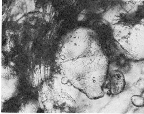
**Figura 2.1** Microfotografía de una emulsión de agua-aceite. <sup>[2]</sup>
