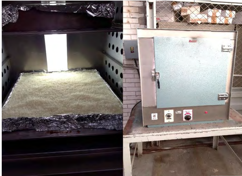
Figura 14. Proceso de secado de PLA y estufa donde se realizó.
