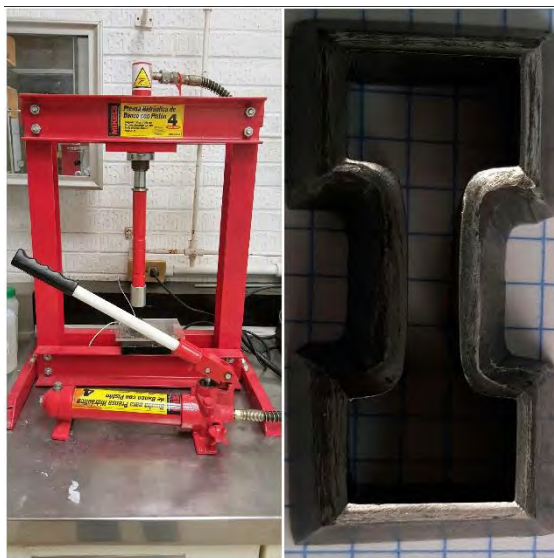
Figura 21. Imagen de la prensa y detalle del suaje utilizados para corte de película.
