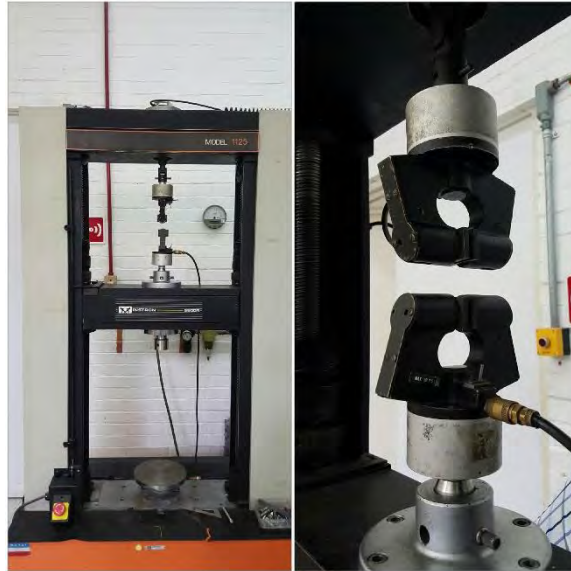
Figura 20. Máquina de ensayos Instron 5500R con detalle de las mordazas utilizadas.
